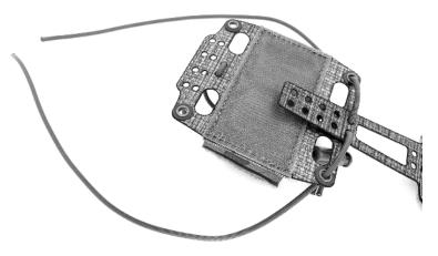
6. LACE THE SAME SHOCK CORD ENDS THROUGH THE UPPER-MOST EYELETS ON THE TOP OF THE BATTERY POUCH (BACK SIDE TO FRONT SIDE).
