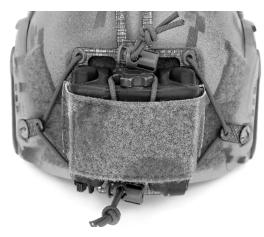
13. TO INSTALL THE PVS-31 BATTERY PACK, MOVE THE SHOCK CORD TO THE SIDE AND WORK THE BATTERY PACK INTO THE TOP SIDE OF THE ELASTIC POUCH. SECURE THE SHOCK CORD OVER THE BATTERY PACK.
